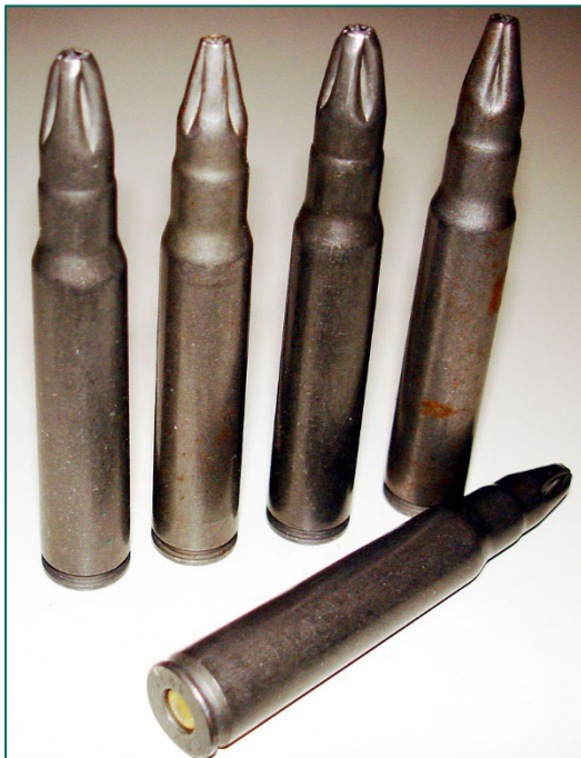
Figuur 6: Een patroon met een kruitlading maar zonder kogel wordt losse patroon, blank of losse flodder genoemd.
