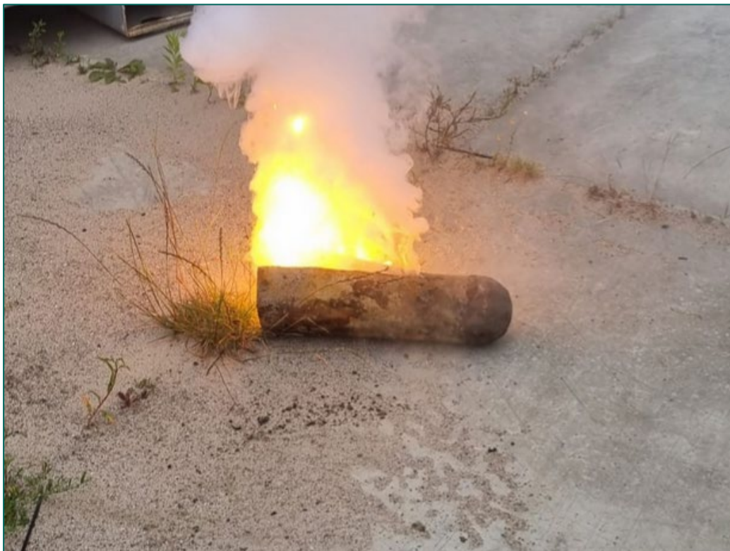
Figuur 26: Voorbeeld van een fosforbrand bij submunitie.
