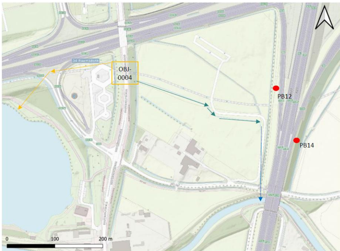
Figuur 4.8: Het bronneringswater aan de oostzijde van de Oosterhoutseweg zal worden geloosd in de tijdelijke watergang naast het bouwterrein (groene pijlen), waar het onder vrij verval richting het oosten stroomt. Vanuit daar wordt het water naar de Donge verpompt middels een portaal over Het Gat (blauwe pijl). Het bronneringswater aan de westzijde van de Oosterhoutseweg wordt deels geretourneerd. Als extra lozingsroute wordt middels een portaal over de toe- en afrit van de A59 in de Veerse plas geloosd.
