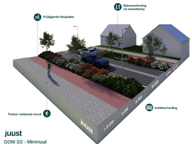
Figuur 7: Minimaal profiel GOW(50)
