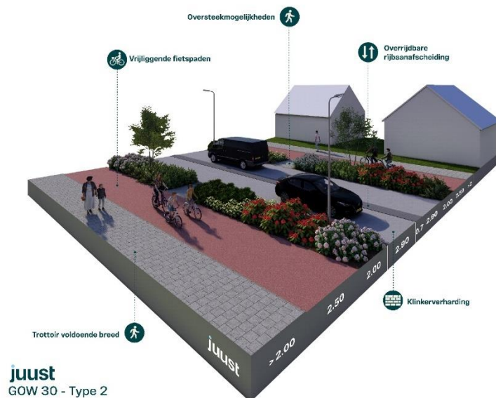
Figuur 5: Profiel GOW(30) type 2
