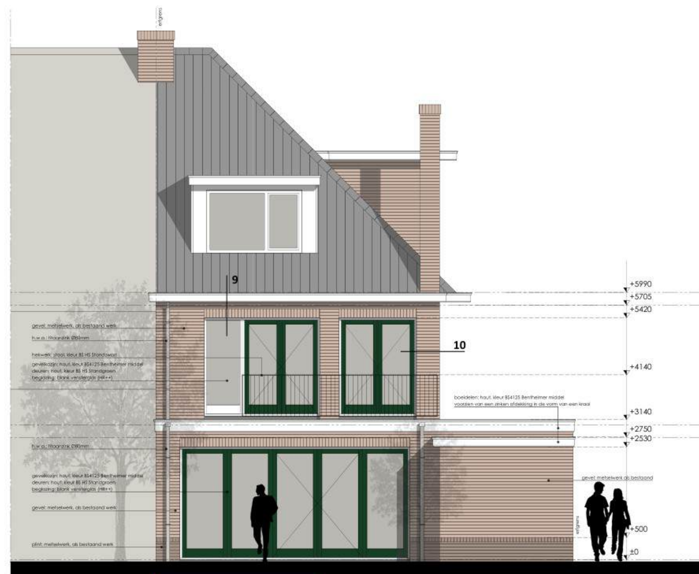
Uitbouw achtergevel is vergunningplichtig achtergevel nieuwe toestand
