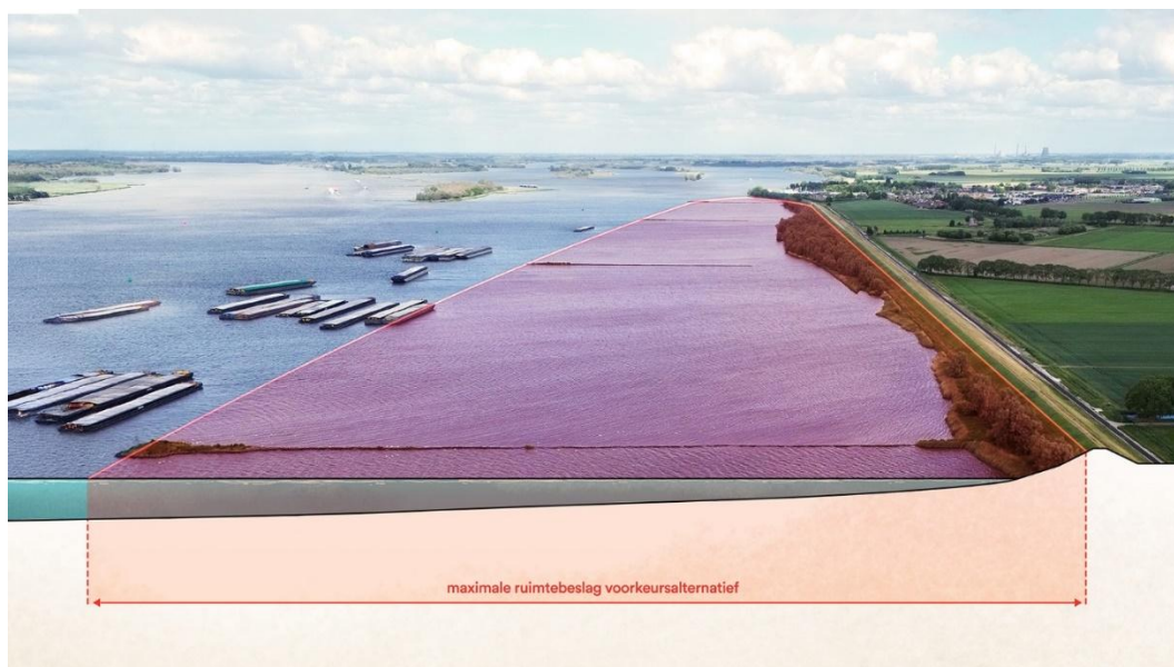
Figuur 6-3 Visualisatie oplossingsrichting en maximaal ruimtebeslag dijkvak 3
