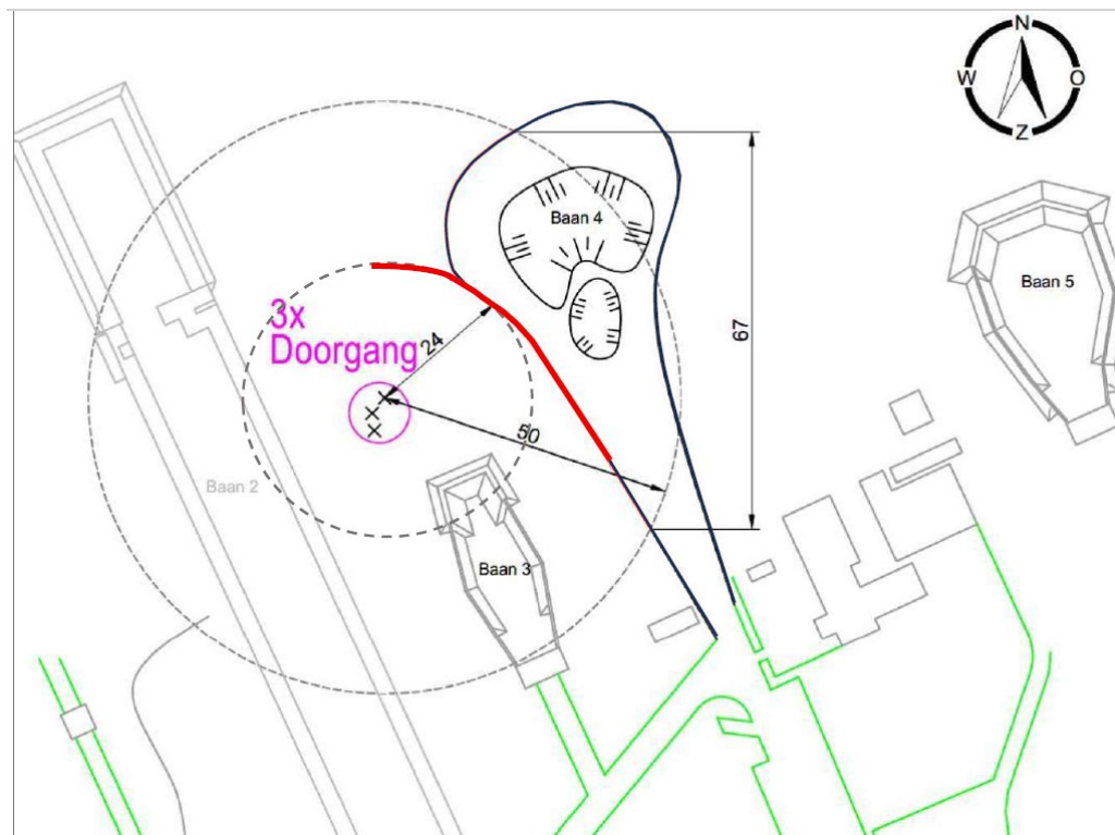
Figuur 2 plaatsing van het geluidsscherm (rode lijn) t.o.v. de burcht (paarse cirkel).
