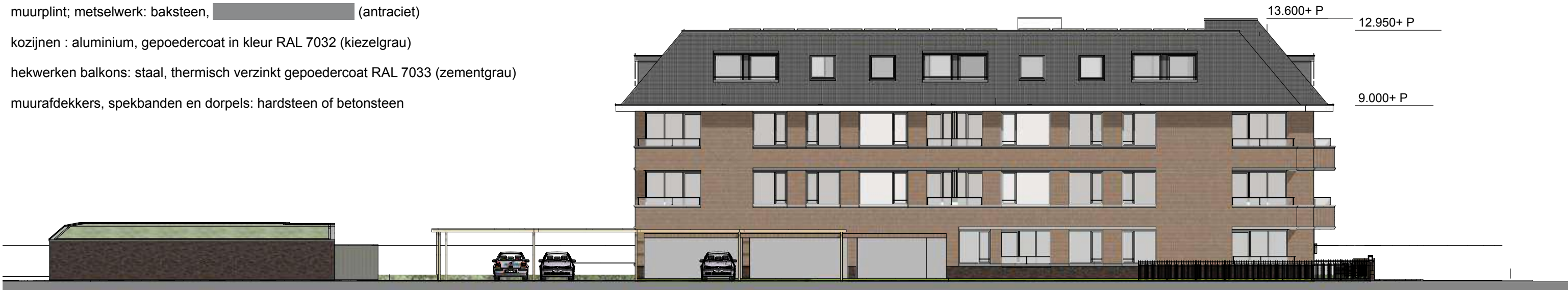
linker zijgevel zuidwestgevel
