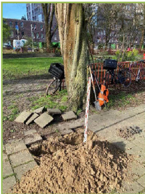
Figuur 13: Proefsleuf bij boom 3 (402039), waarbij oppervlakkige wortels loodrecht naar beneden groeien.
