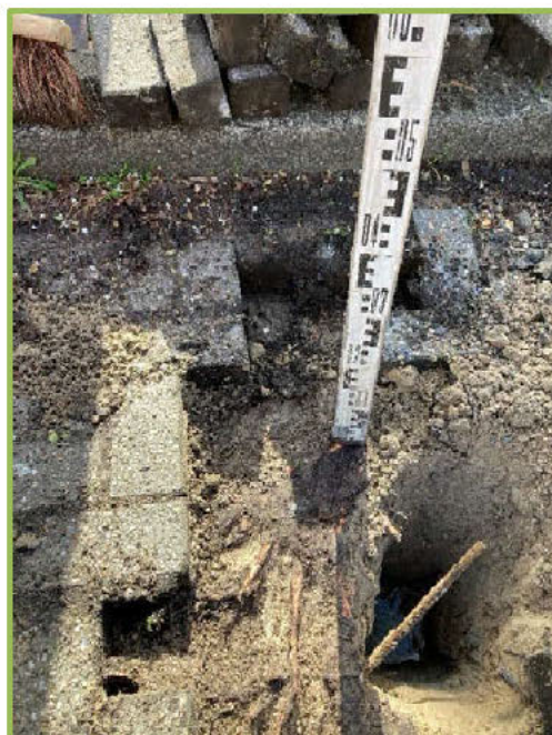
Figuur 14: Proefsleuf bij boom 5 (406772), waarbij direct onder de verharding oppervlakkige wortels groeien. Het grondwaterpeil is op 40 cm -mv aangetroffen.
