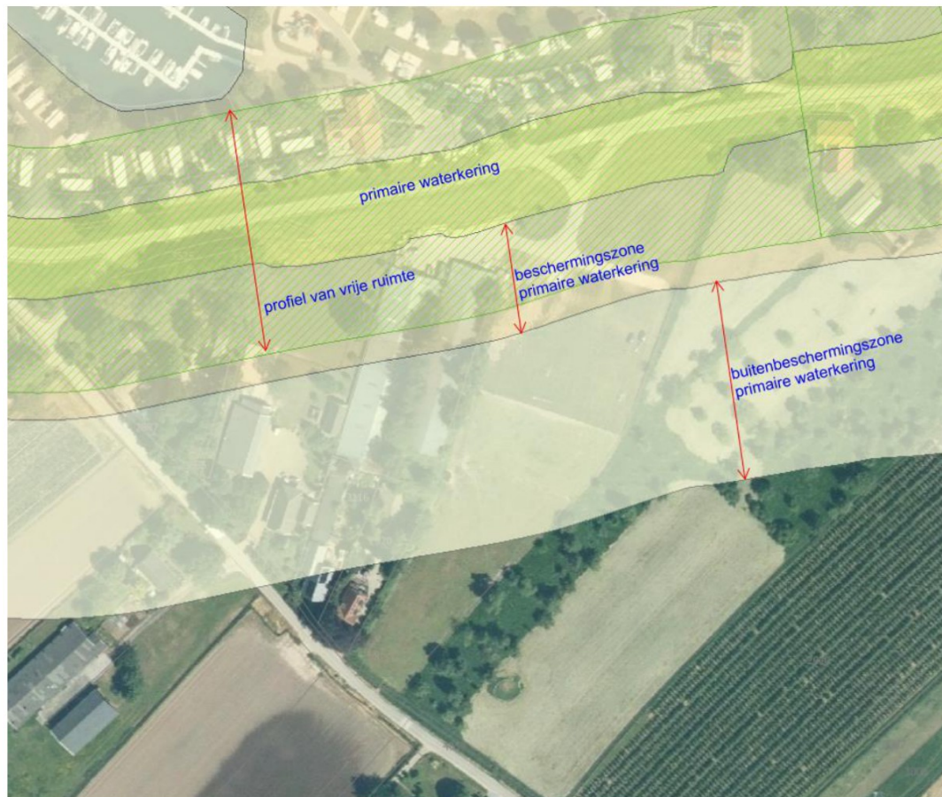
Figuur 2: Legger waterkering waterschap Rivierenland
