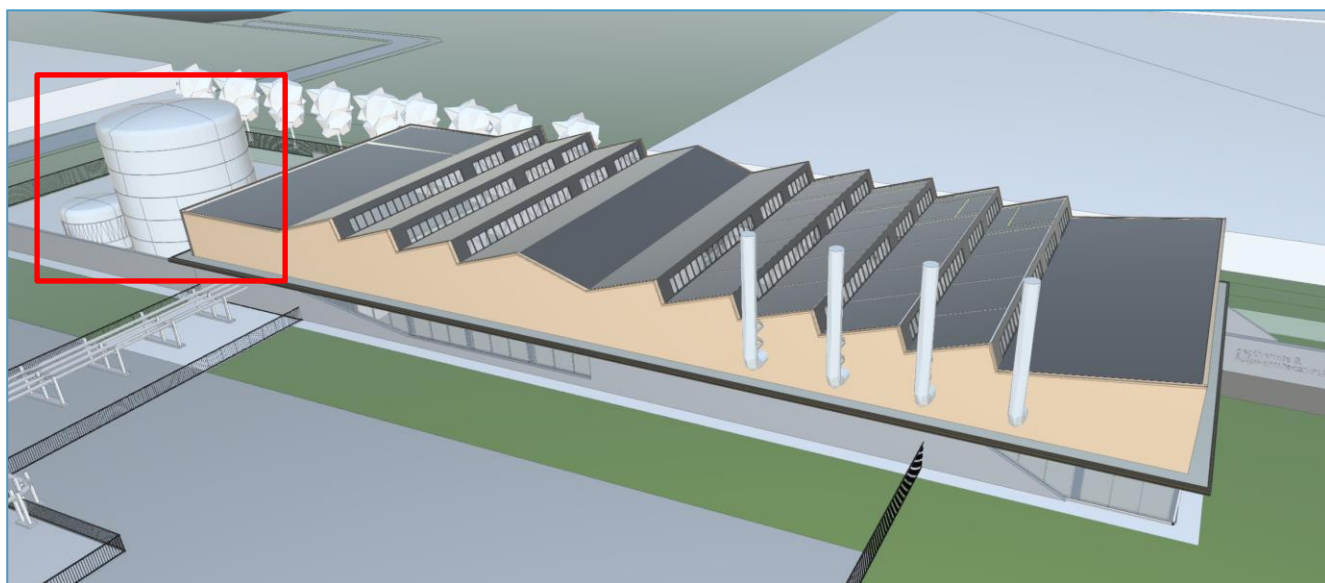
Figuur 1-3 3D-impressie 'gebouw' GeoThermie met buffervaten Heerhugowaard
