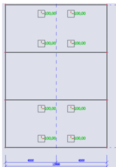
Figuur 2-1: schematisatie puntlasten op de vloer
