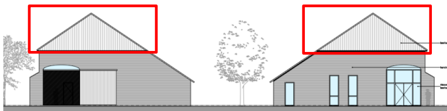
Figuur C2: Verschijningsvorm van het schilddak gezien van de voor- en achtergevel (dak met rood omlijnd)
