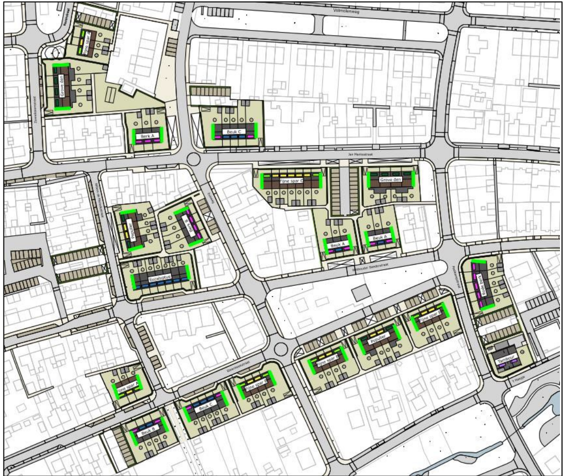
Figuur 8: Locaties van de permanente voorzieningen voor de laatvlieger in de nieuwbouw (groene lijnen).
