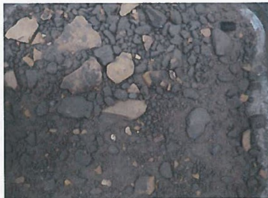
Figuur 8. Dämmer boring B-02, MG-05 2,6-4 m - maaiveld
