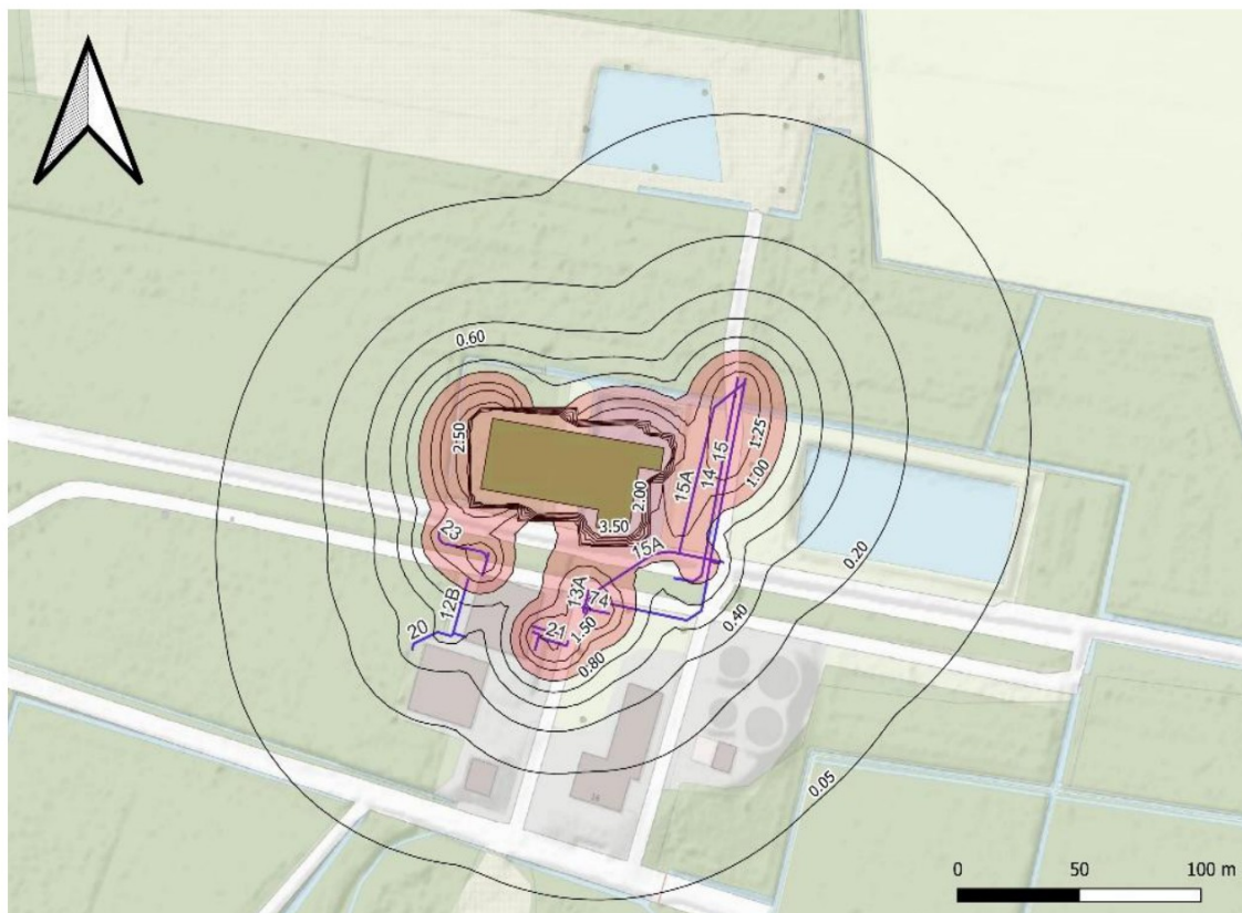
Figuur 3.1: Verlagsingscontouren van de bemaling en maximale reikwijdte (verlaging <0,05 m) met lager dan GLG rood gearceerd
