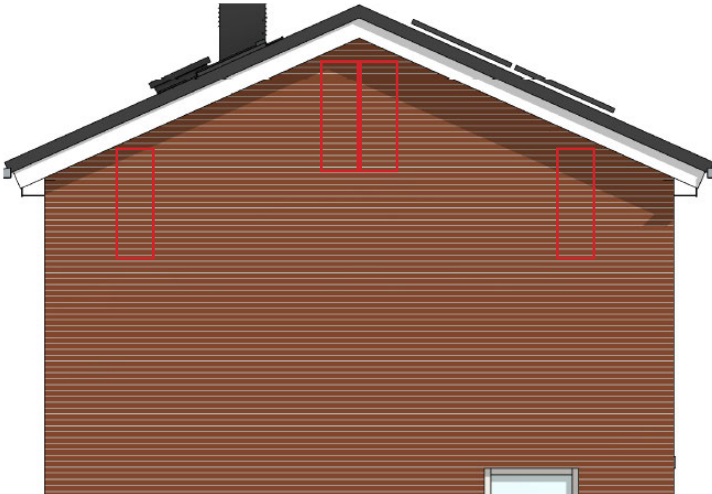
Afbeelding 2: Schematische weergave van een 'lege' kopgevel met daarop aangegeven op welke wijze nieuwe voorzieningen ingepast kunnen worden. In rood de locaties voor permanente inbouwkasten voor vleermuizen. De in te passen kasten in de nok worden zoveel mogelijk geschakeld aangebracht. Permanente alternatieve verblijfplaatsen geschikt als kraamverblijf worden op dezelfde wijze ingepast, namelijk in de nok van te verduurzamen woningen.
