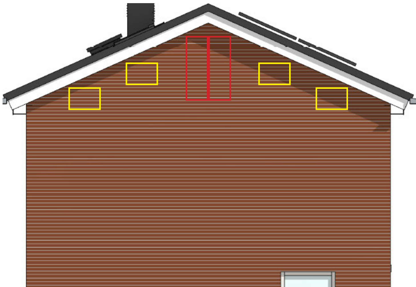
Afbeelding 3.3: Indicatieve, schematische weergave van een 'lege' gevel met daarop aangegeven op welke wijze nieuwe voorzieningen ingepast kunnen worden. In rood de locaties voor permanente inbouwkasten voor vleermuizen en in geel de locaties voor permanente inbouwkasten voor gierzwaluwen/huismussen. De exacte locaties moeten voor dit project nog uitgewerkt worden.
