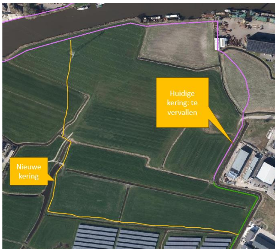
Figuur 5: verlegging kering t.b.v. peilwijziging
