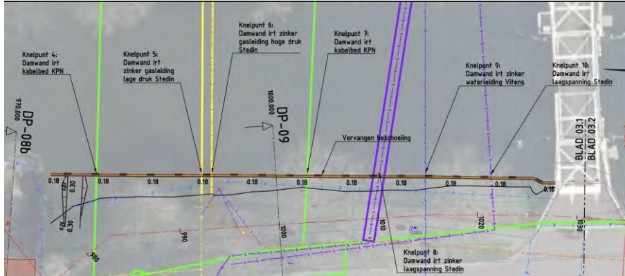
Figuur 5: Knelpunten vanwege kabels en leidingen.
