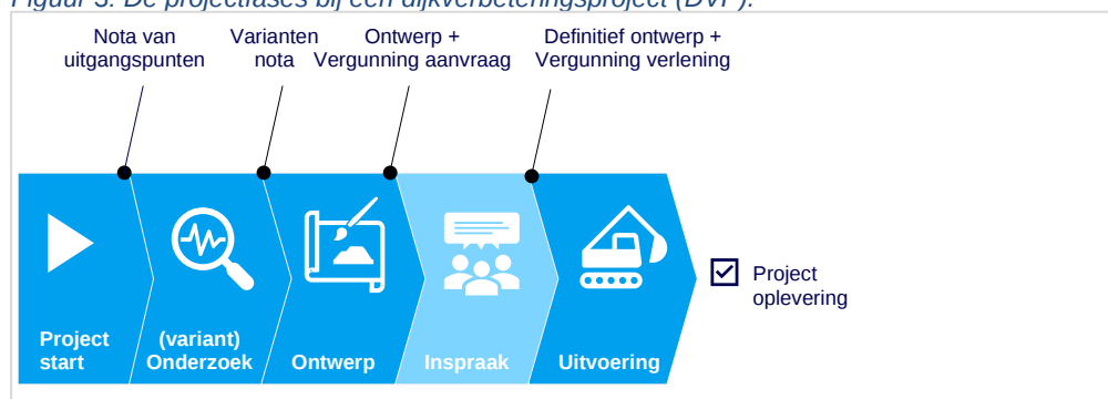
Figuur 3: De projectfasen bij een dijkverbeteringsproject (DVP).
