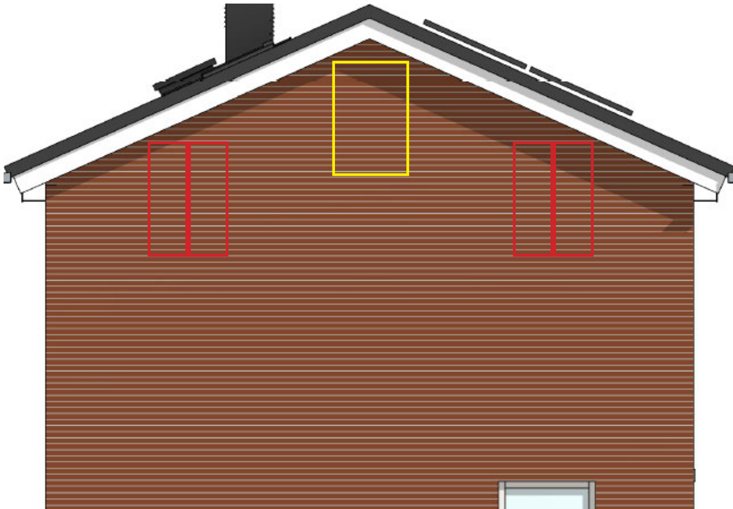
Afbeelding 6: Schematische weergave van een 'lege' kopgevel met daarop aangegeven op welke wijze nieuwe permanente voorzieningen ingepast zullen worden. In rood de locaties voor permanente inbouwkasten voor vleermuizen geschikt als zomer-/paarverblijfplaats en in geel een voorziening geschikt als kraamverblijfplaats. De kast in rood aangegeven betreffen 2 kasten die geschakeld zullen worden aangebracht. Deze weergave is van toepassing op 1 van de 3 adressen waar isolatie-werkzaamheden zullen plaatsvinden.
