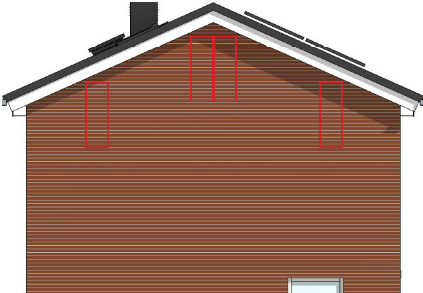
Afbeelding 5: Schematische weergave van een 'lege' kopgevel met daarop aangegeven op welke wijze nieuwe permanente voorzieningen ingepast zullen worden. In rood de locaties voor permanente inbouwkasten voor vleermuizen. De kasten in het midden betreffen 2 kasten die geschakeld zullen worden aangebracht. Deze weergave is van toepassing op 2 van de 3 adressen waar isolatie-werkzaamheden zullen plaatsvinden.
