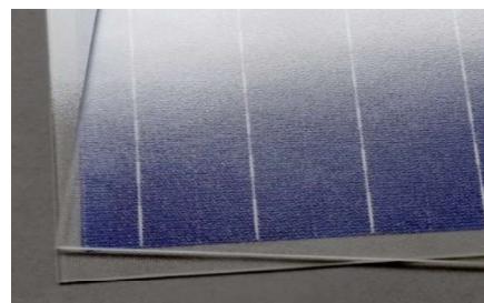
Diffuus oppervlak van zonnepanelen
