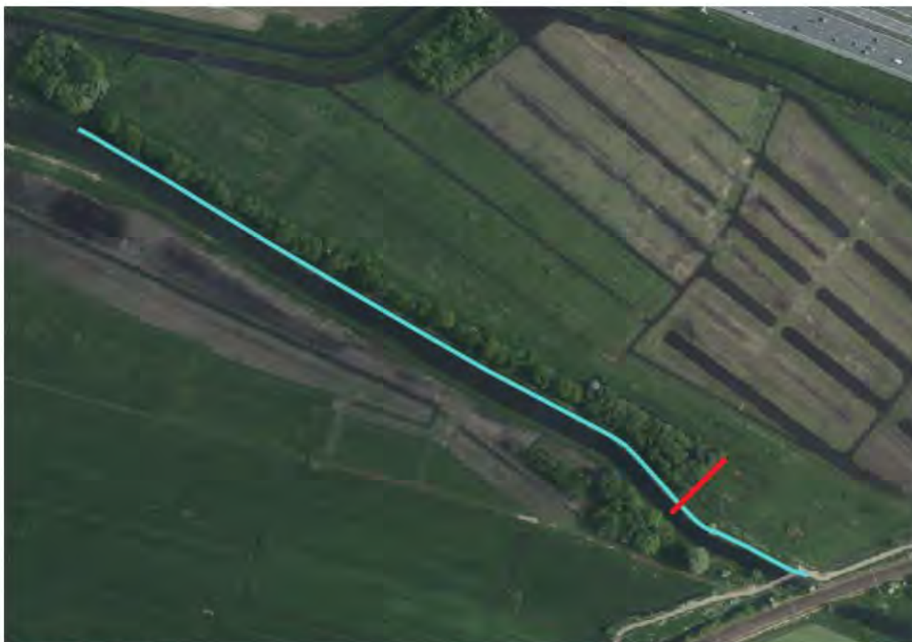
Figuur 16: Dijkvak 6 in het traject Uitwateringskanaal Naardermeer. Ten westen van de rode lijn dient de teensloot te worden vergraven.
