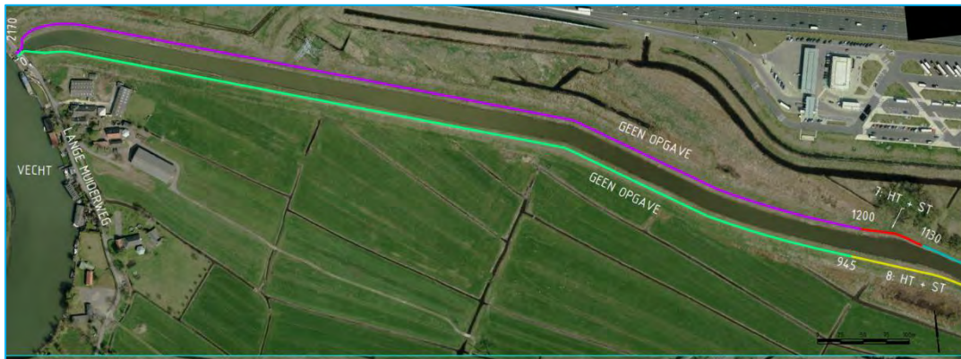
Figuur 2-1: Dijkvakindeling en veiligheidsopgave* westzijde (V229 en V240). De getallen zijn de metring van de dijkvakken
