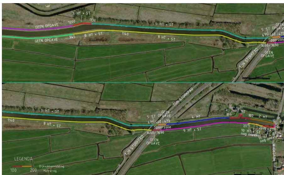
Figuur 3-1: Dijkvakindeling met veiligheidsopgave (HT=hoogte, ST=binnenwaartse stabiliteit).
