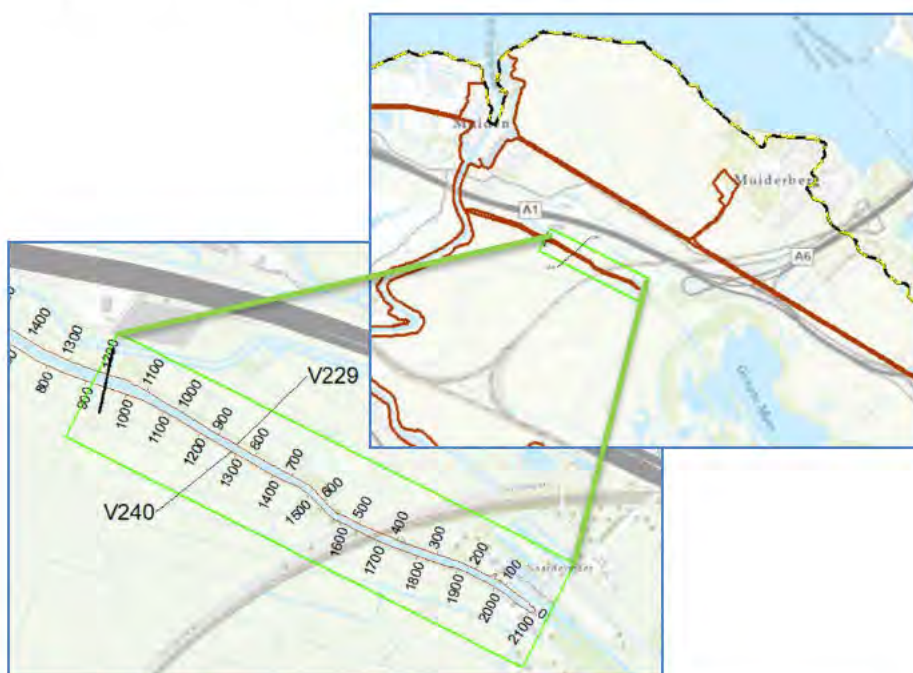
Figuur 1-1 Dijktrajecten V229 en V240 (rode lijn) en binnen het groene kader het afgekeurde gedeelte (projectgebied).
