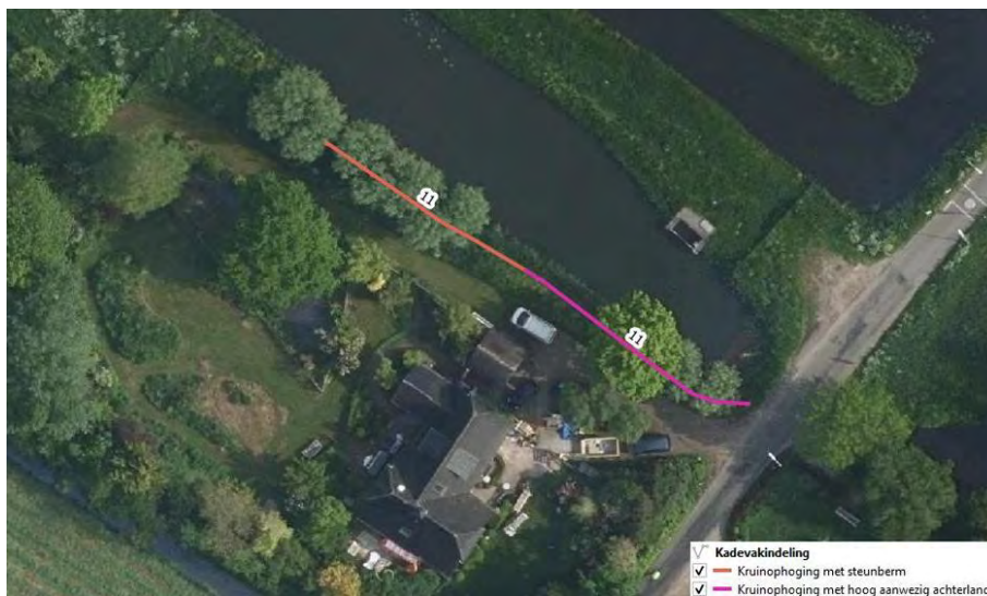
Figuur 2-7: Dijkvak 11 en de verschillende maatwerkoplossingen.
