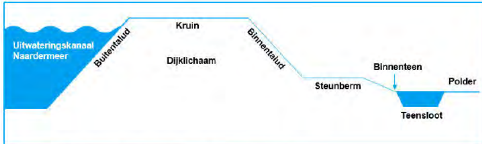
Figuur 0-1 Principeschets van de huidige dijk - begrippen
