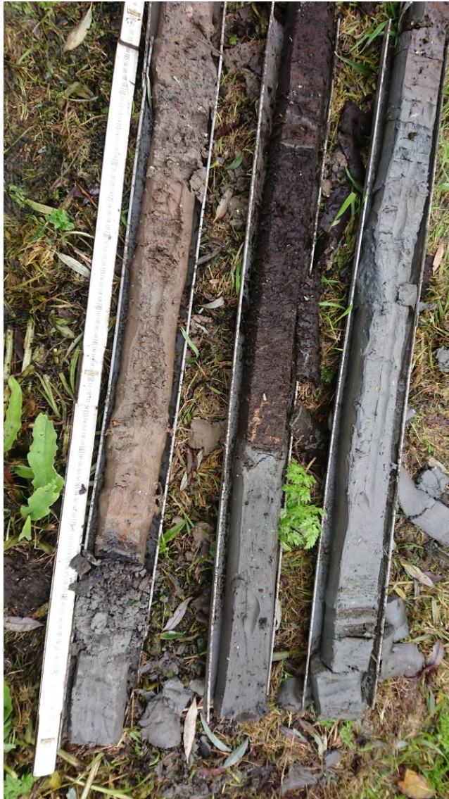
Afbeelding 4: Voorbeeld van één van de boorkernen, goed zichtbaar is de leesbaarheid van de bodem dankzij de ongeroerde monsternamen.
