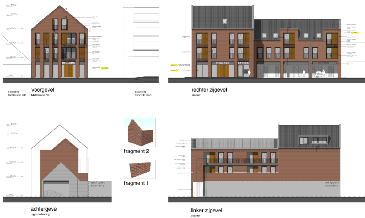
Figuur 2. Gevelaanzicht plan Middenweg 243 Heerhugowaard (Afbeelding SD-A Sander Douma architecten)
