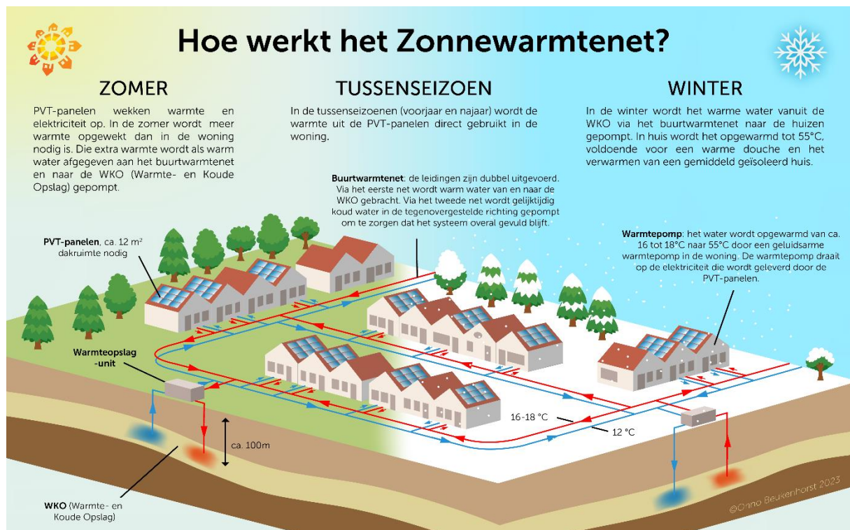
Figuur 5 – Hoe werkt het Zonnewarmtenet in het Ramplaankwartier?
