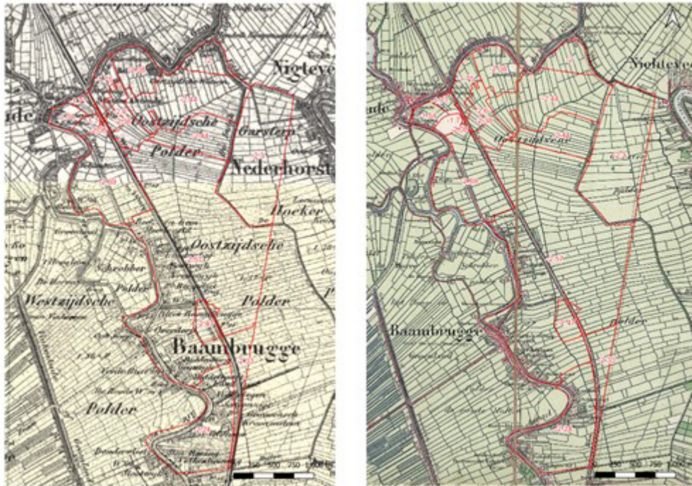
Figuur 3.2 Topografische kaarten Oostzijdsche Polder in 1870 (links) en 1893 (rechts). Links staat nog een polderpeil aangegeven (1,37-P), rechts zijn de contouren van het nieuwe kanaal gemarkeerd.
