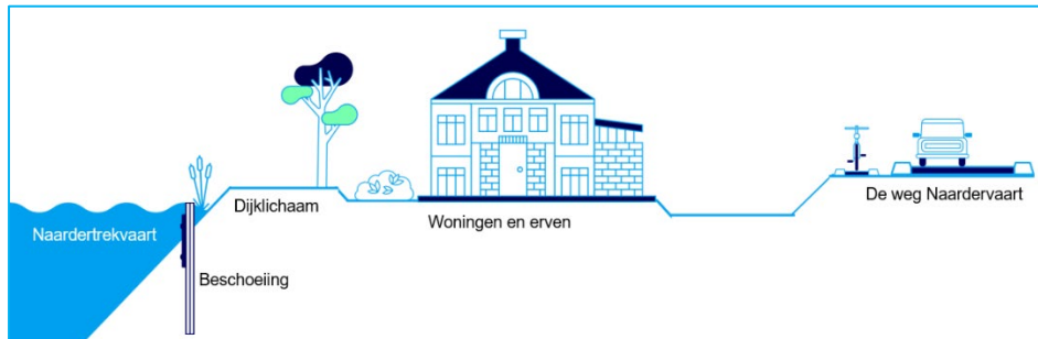
Figuur 0-1 Principeschets van de huidige dijk ter hoogte van de Hakkelaarsbrug - begrippen
