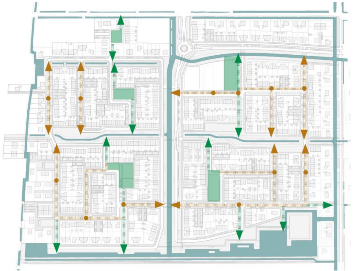
Structuur oppervlakkige afvoer regenwater
