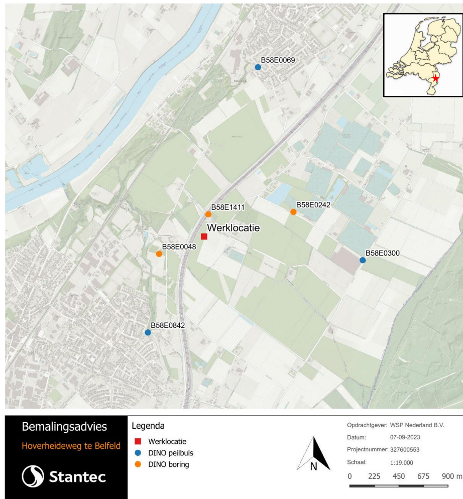
Figuur 1: Ligging van de werkput. Eventuele representatieve boringen uit DINOloket zijn weergegeven in oranje, sondering van Koops in geel, peilbuizen uit DINOloket in blauw en lokale boringen en peilbuizen zijn weergegeven in groen.
