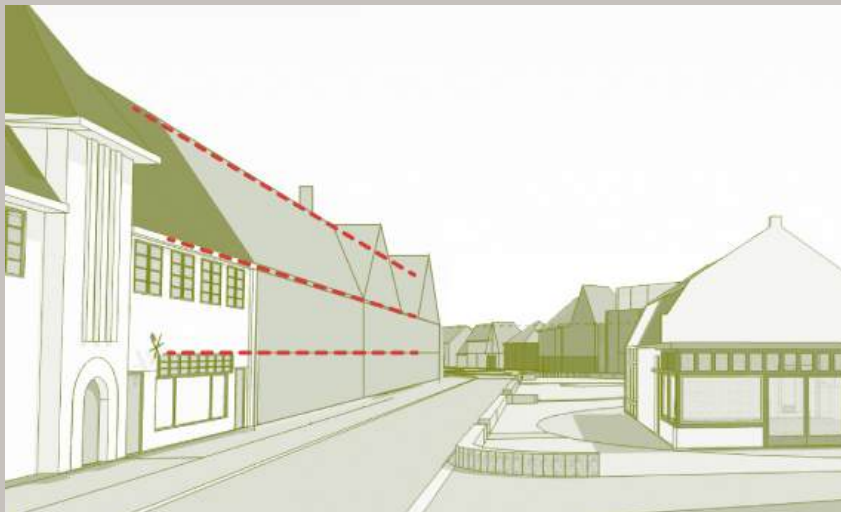
Aansluiten met nieuwe bebouwing op vormtaal en XX Café Dudok. Ook bij grotere hoogte van de nieuwbouw of bij een andere kapvorm is deze visuele connectie van belang.
