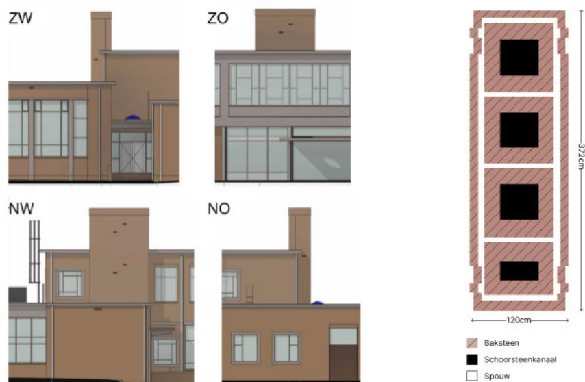
Figuur 5: Opbouw van de alternatieve massawinterverblijfplaats voor gewone dwergvleermuis in de schoorsteen.
