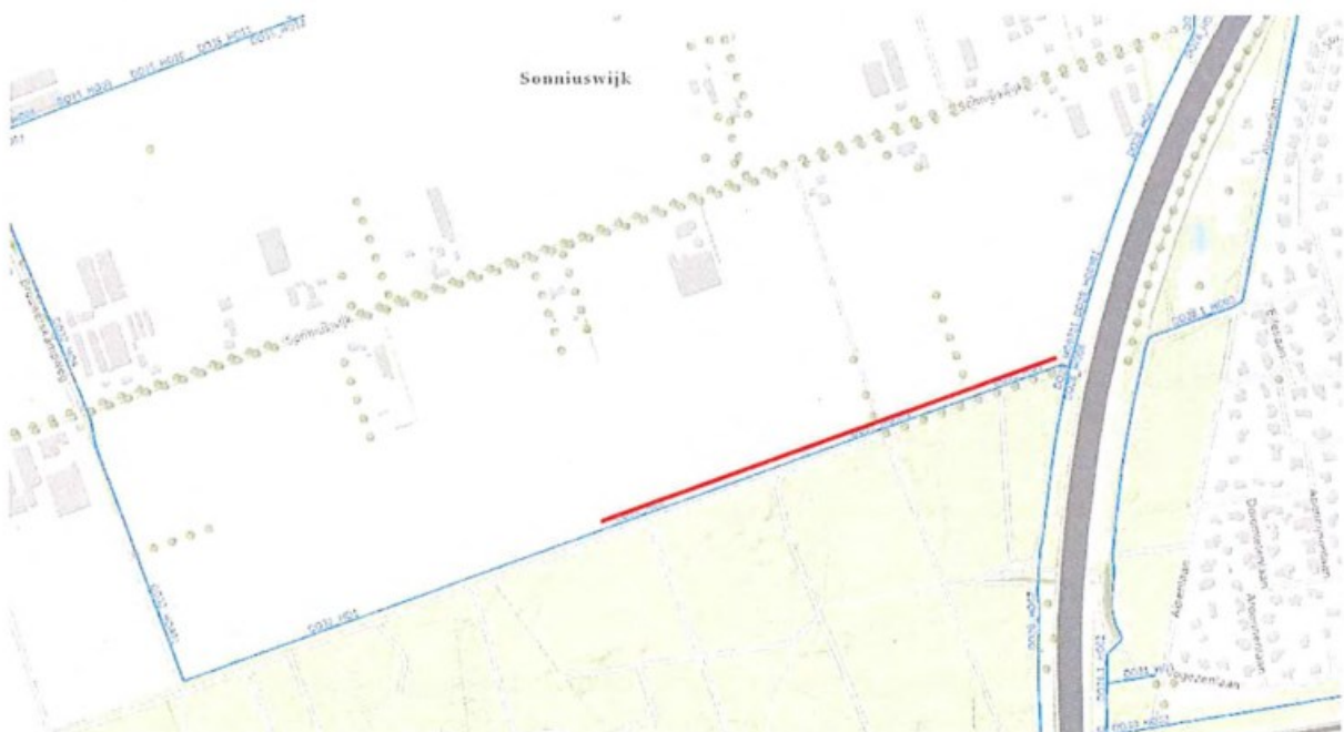
Afbeelding 1. Geplande ligging van de grondwal met parallelsloot naast watergang DO32. De ligging is met de rode lijn aangegeven.
