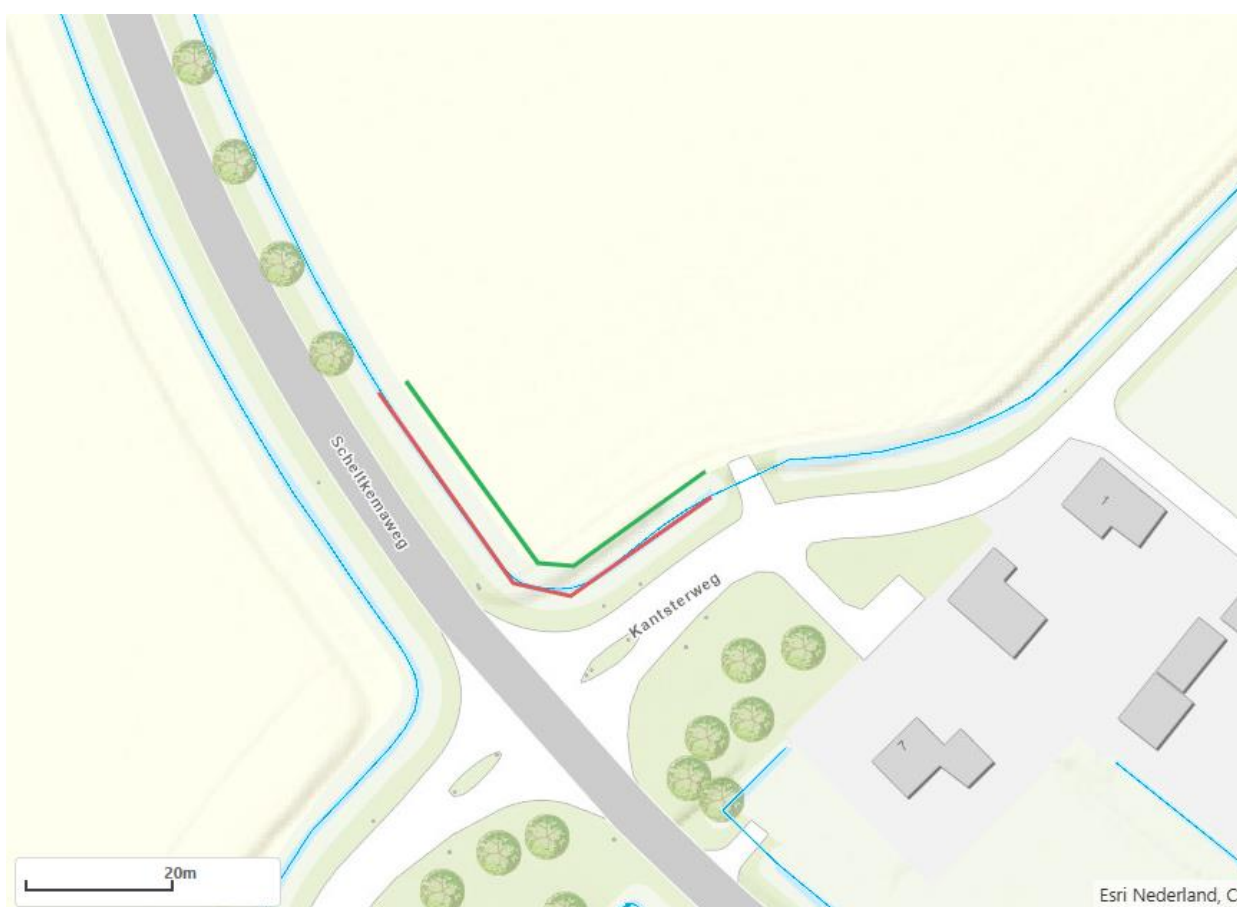
Figuur 1: De rode lijn geeft het oppervlaktewaterlichaam weer die wordt gedempt, de groene lijn is het nieuwe oppervlaktewaterlichaam.
