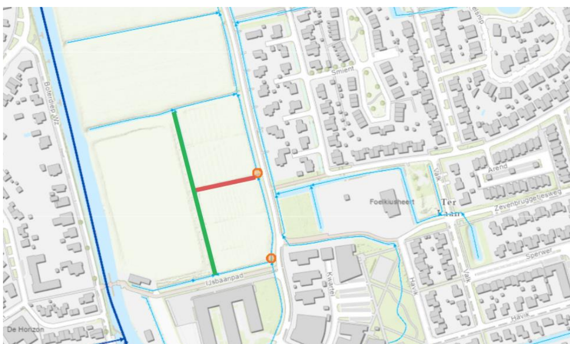
Figuur 1: Locatie van activiteiten. De rode lijn geeft te dempen watergang weer. De groene lijn geeft de te verbreden watergang weer. De oranje cirkels geven de vaste dammen weer, waarvan één dient te worden voorzien van een duiker.
