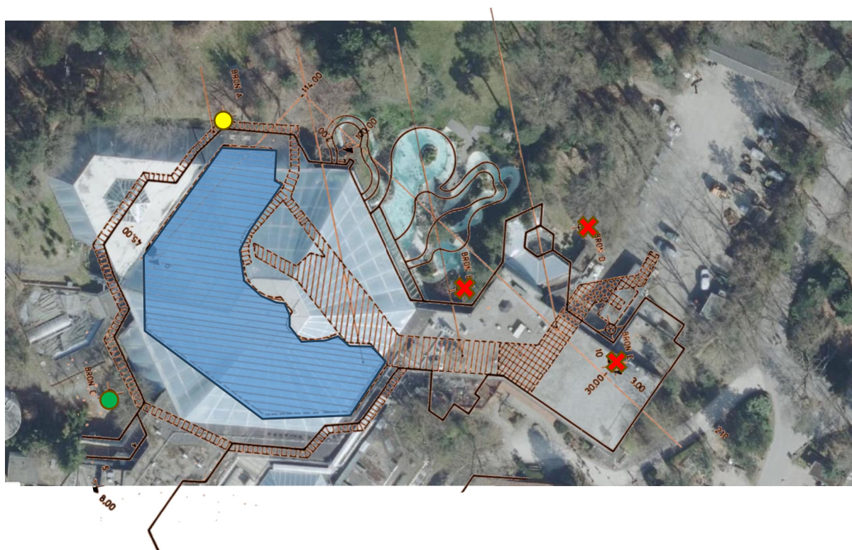
Figuur 1-3 Projectie bouwplan over actuele luchtfoto. Groene bol: grote diameter grondwaterbuis aanwezig, gele bol: kleine diameter grondwaterbuis aanwezig, rood kruis: niet aangetroffen grondwaterbuis
