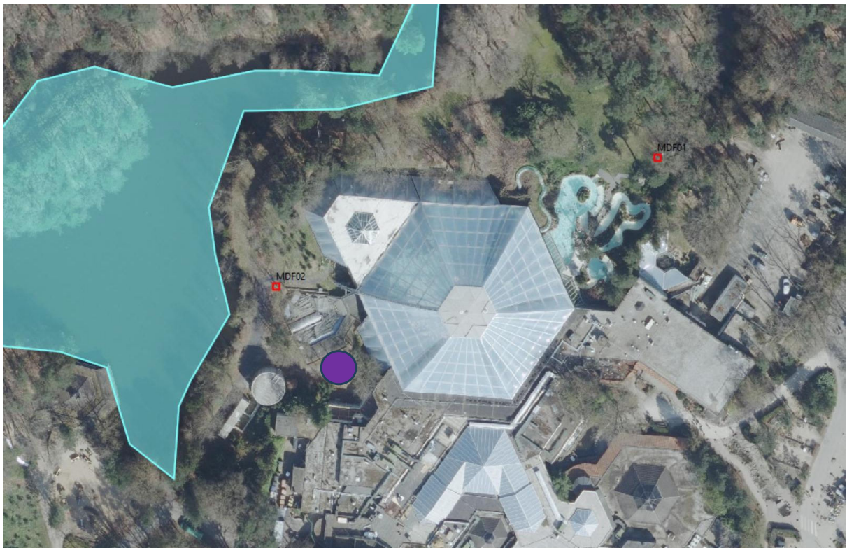
Figuur 4-1 Principeschets bemalingsplan, met in paars de positie van de onttrekkingsbron en in rood monitortingsfilters
