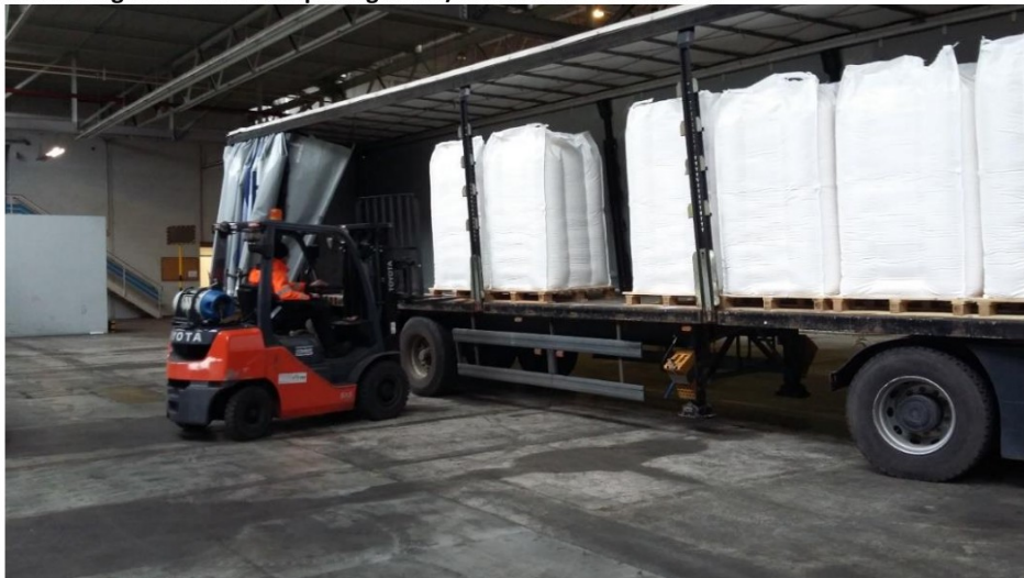
Afbeelding 4.3: overzicht inpandig laden/lossen met LPG heftruck
