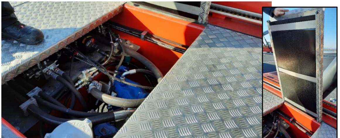
Afbeelding 2.4: Kalmar DRG 450 Eco met geïsoleerde platen t.p.v. motorcompartiment
