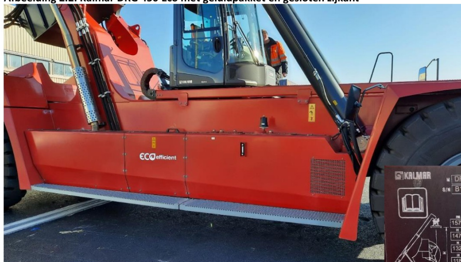
Afbeelding 2.2: Kalmar DRG 450 Eco met geluidpakket en gesloten zijkant
