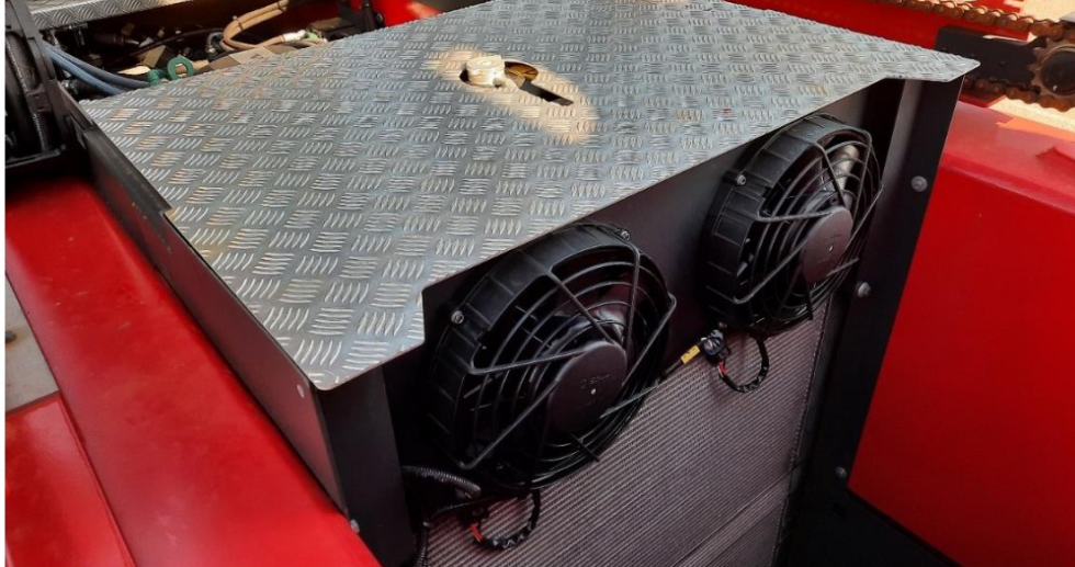
Afbeelding 2.6: Kalmar DRG 450 Eco met Volvo motor en radiator
