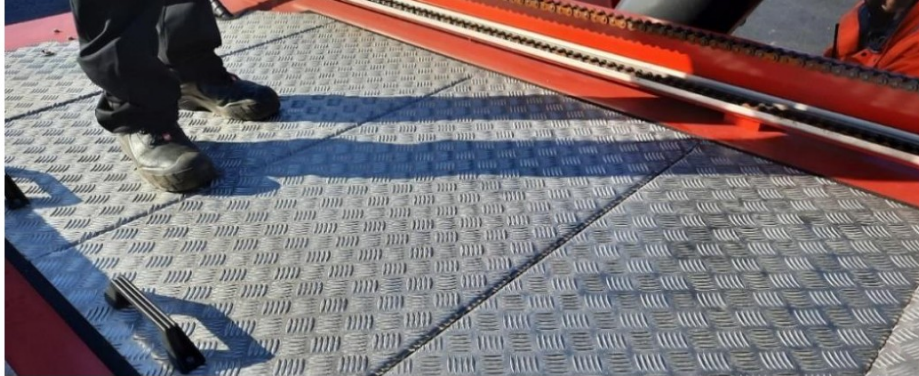
Afbeelding 2.3: Kalmar DRG 450 Eco met geïsoleerde platen aan de bovenzijde motorcompartiment
