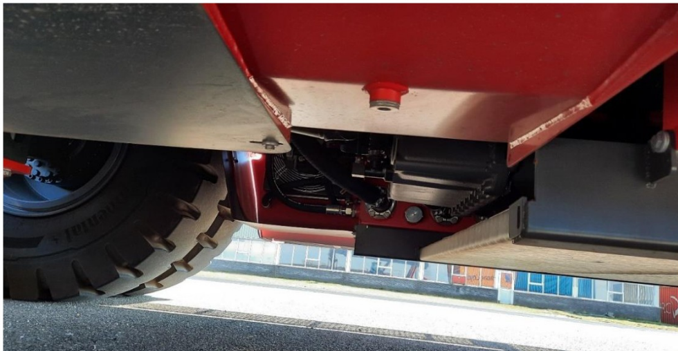
Afbeelding 2.8: Kalmar DRG 450 Eco met geïsoleerde platen t.p.v. motorcompartiment
