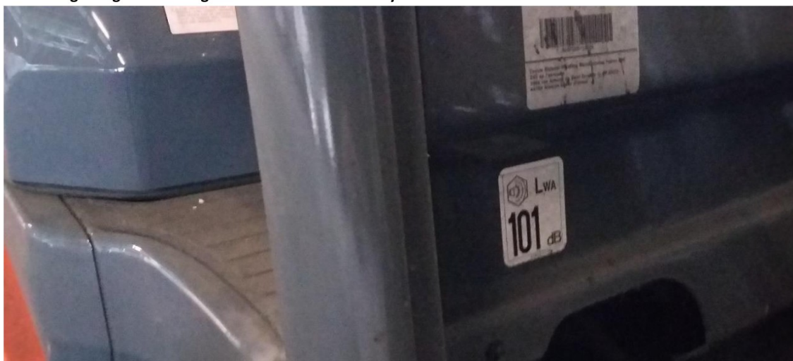
Afbeelding 5.2: geluidvermogenniveau LPG heftruck Toyota
