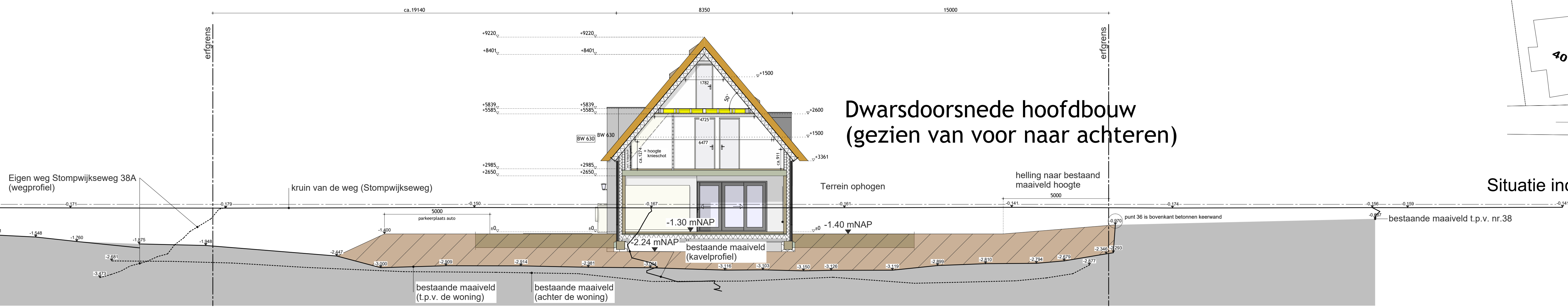
Dwarsprofiel t.o.v. profiel van vrije ruimte van de waterkering met maatvoering t.o.v. NAP Kern- en beschermingszone van de ter plaatse aanwezige regionale waterkering van de Nieuwe Driemanspolder (Hoogheemraadschap van Rijnland)
