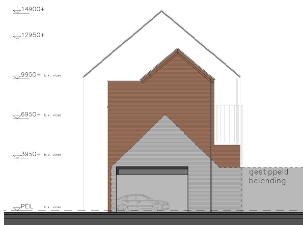
achtergevel tegen belending
