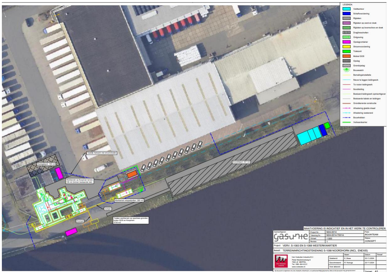
Figuur 1: Overzichtstekening van het aan te leggen gasleidingschema en het tijdelijke gronddepot.
