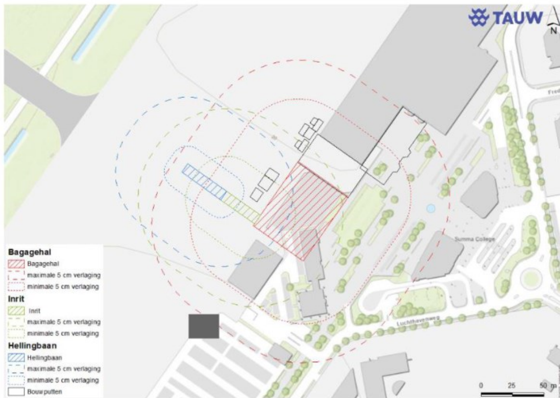
Figuur 4.1. Verlagscontouren bemaling freatische pakket
