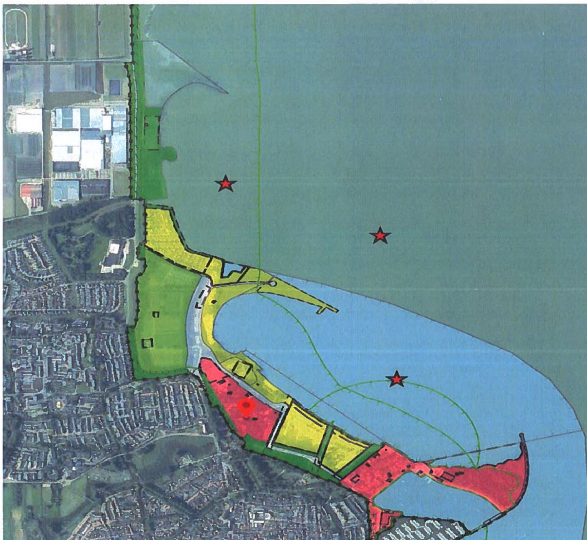
Figuur 2. Locaties monitoringspunten vertroebeling IJsselmeer tijdens aanleg Kustboog.
