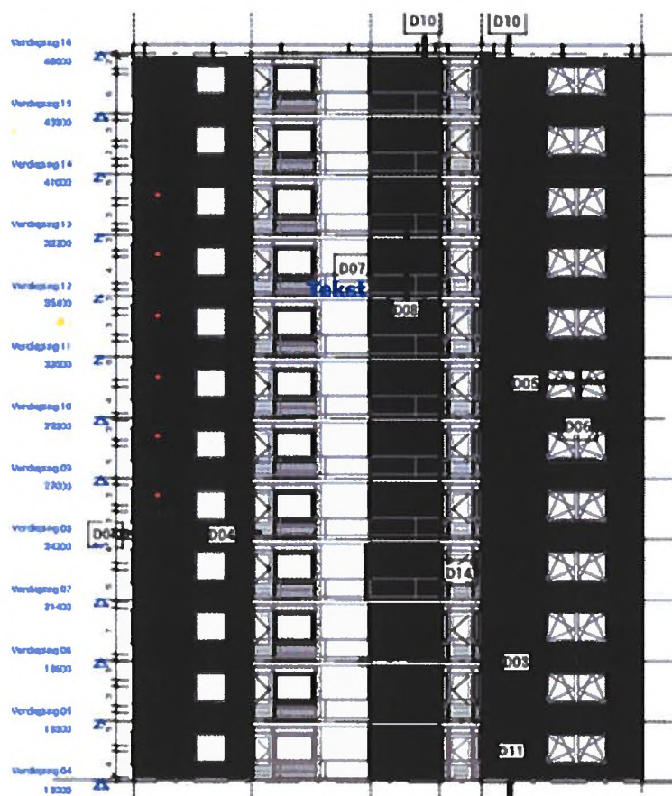
Figuur 1. Locaties van de toegangsbuizen op de gevel (weergegeven als rode stippen). Aan alle gevels van de bebouwing wordt één toegangsbuis gerealiseerd op de 9de t/m 14de verdieping. Per gevel worden zes toegangsbuizen gerealiseerd en in totaal worden in de bebouwing van het plangebied 24 toegangsbuizen gerealiseerd.
