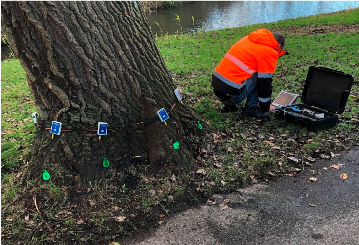
Afbeelding 5: Inzet van de Picus geluidstomograaf bij een abeel aan de Veurselaan
