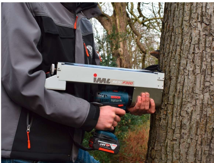
Afbeelding 4: Voorbeeld van de inzet van de resistograaf
