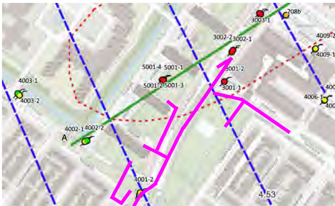
Figuur 2-4: Grondwaterverontreiniging op locatie Holtroplan, roze lijn is te vervangen riolering (bron: Concept-eindrapport Galvanitas, 1 augustus 2013)
