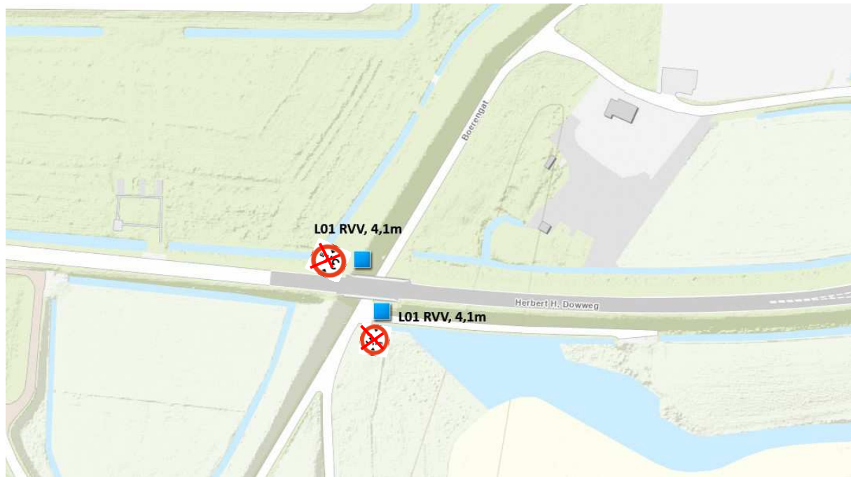
Figuur 1: Locatie viaduct Boerengat / Herbert H. Dowweg te Hoek, RVV bord L1 4,1m i.p.v. bord C19.
