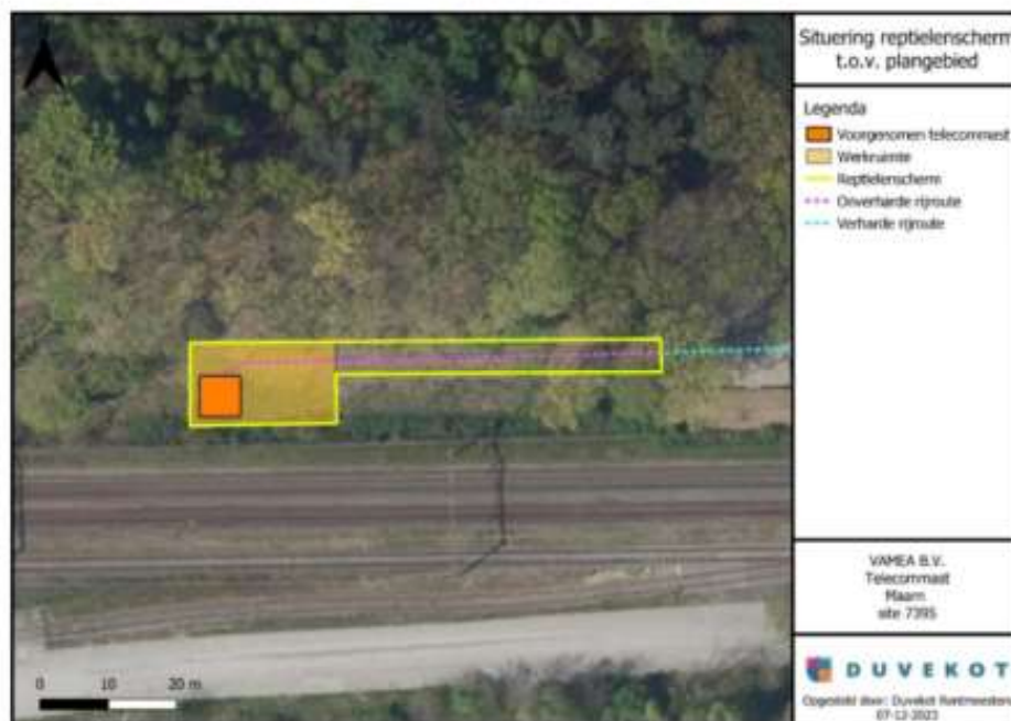
Figuur 6.1. Bij benadering situering van reptielscherm t.o.v. benodigde werkruimte en onverharde rijroute. Daadwerkelijke werkruimte en rijroute worden in het veld bepaald.
