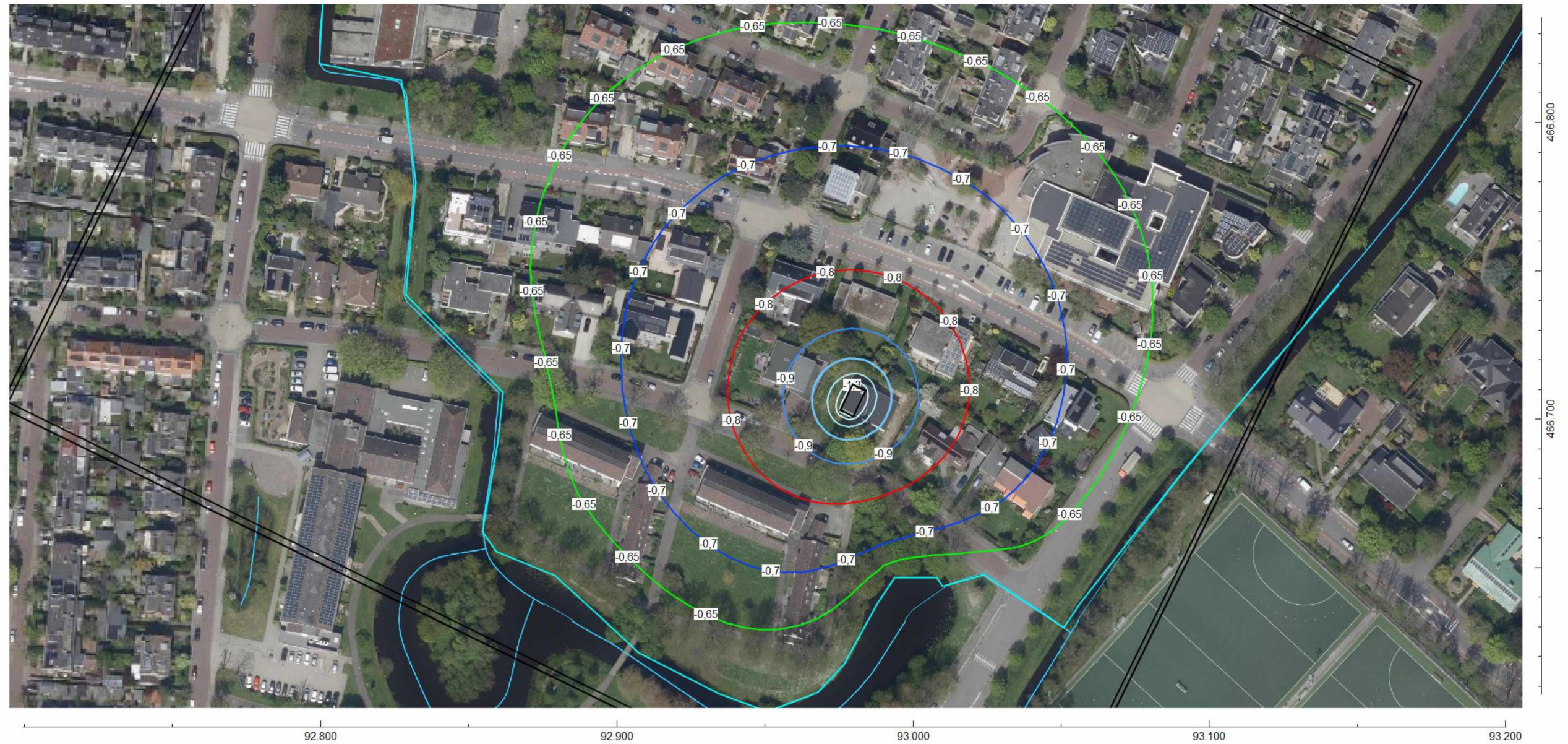
Figuur 4-8 Isohypsens [m NAP] na 8 weken VERTICALE bemaling, onder GMG-condities (-0,6 m NAP). In rood is de GLG-contour weergegeven (-0,8 m NAP), in groen de 5-cm verlagingscontour (-0,65 m NAP)
