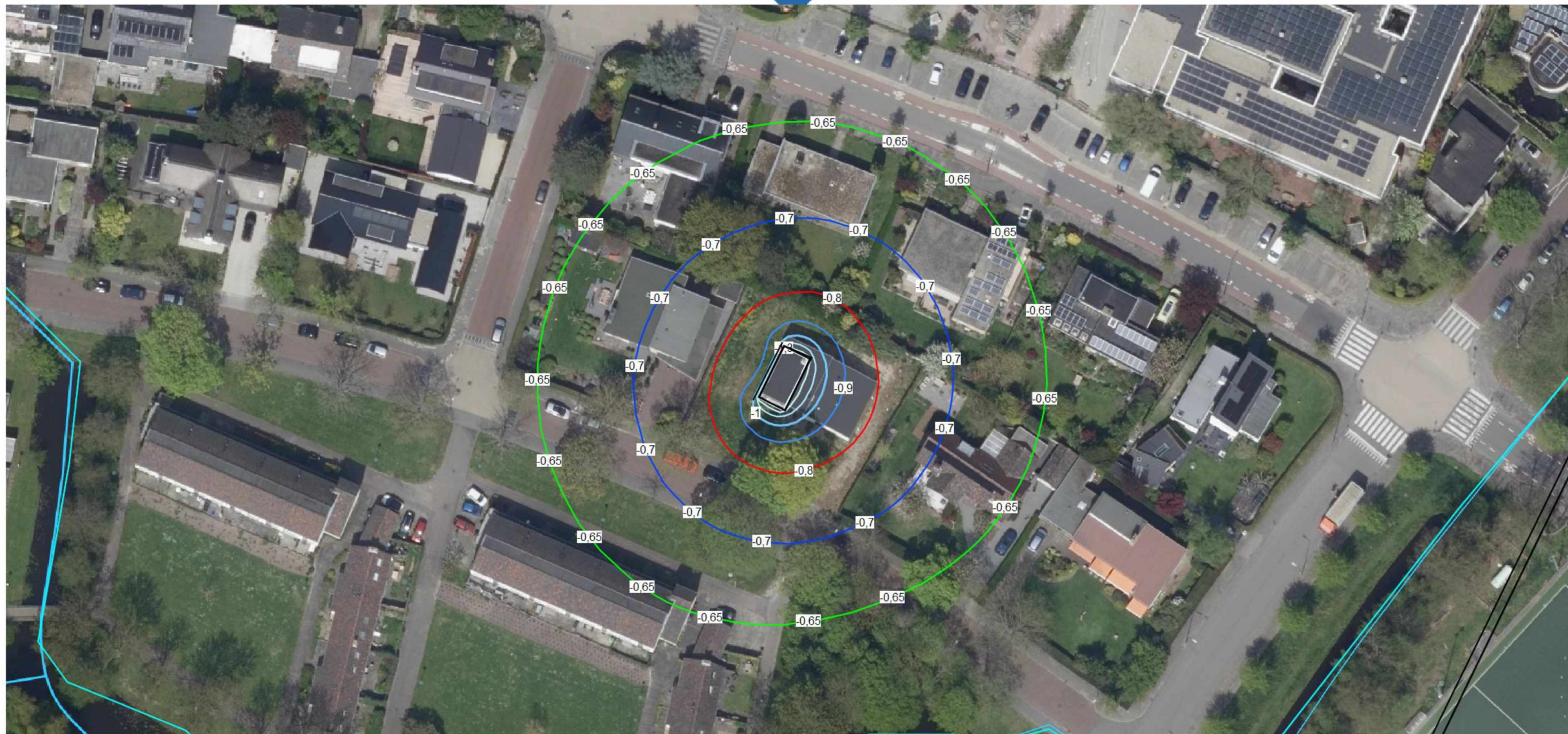
Figuur 4-7 Isohypsens [m NAP] na 8 weken OPEN bemaling MET WATERKERENDE WAND AAN DE WESTZIJDE, onder GMG-condities (-0,6 m NAP). In rood is de GLG-contour weergegeven (-0,8 m NAP), in groen de 5-cm verlagingscontour (-0,65 m NAP)
