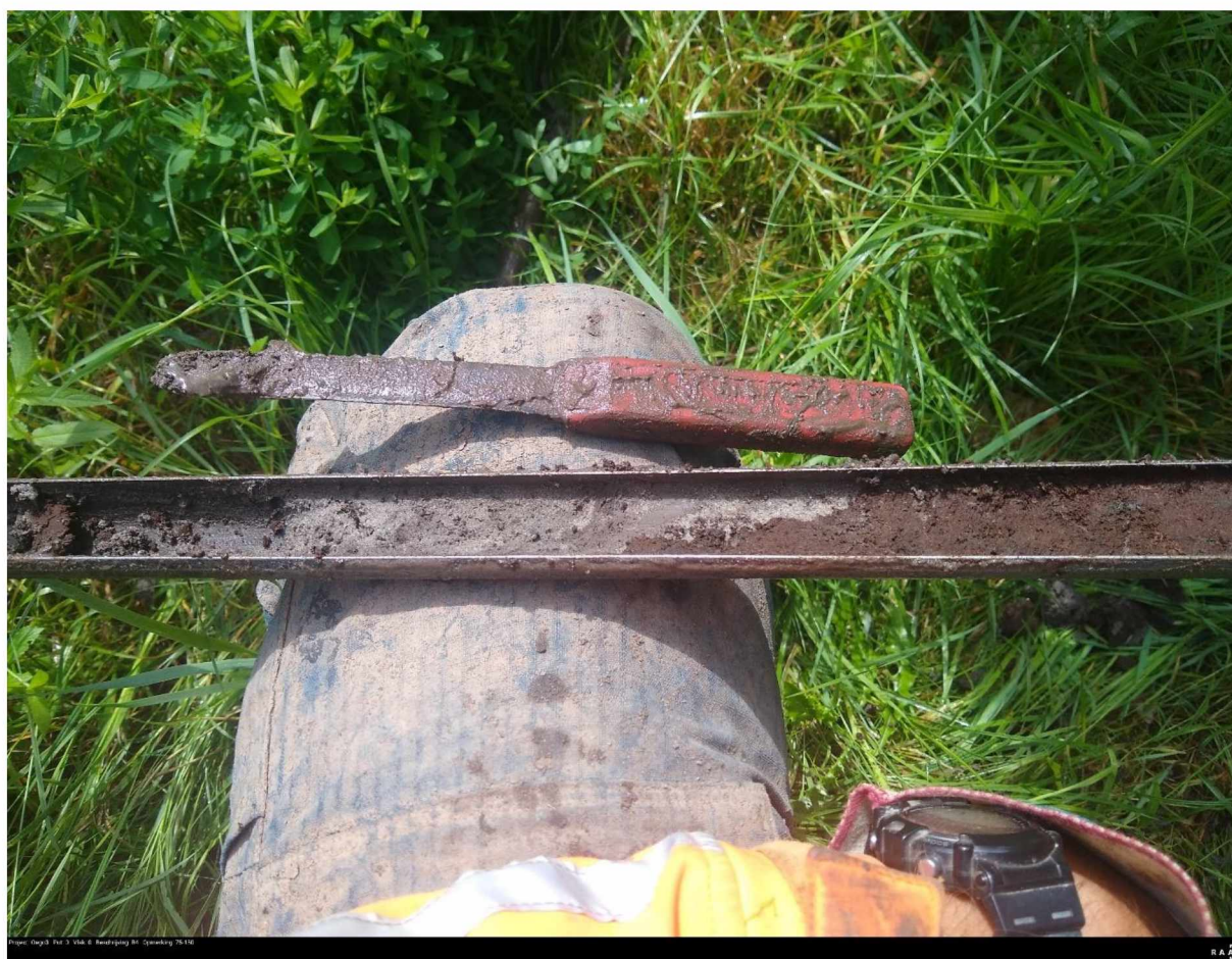
Figuur 5. De erosieve overgang van de kreekgeulafzettingen naar het veen in boring 4.
