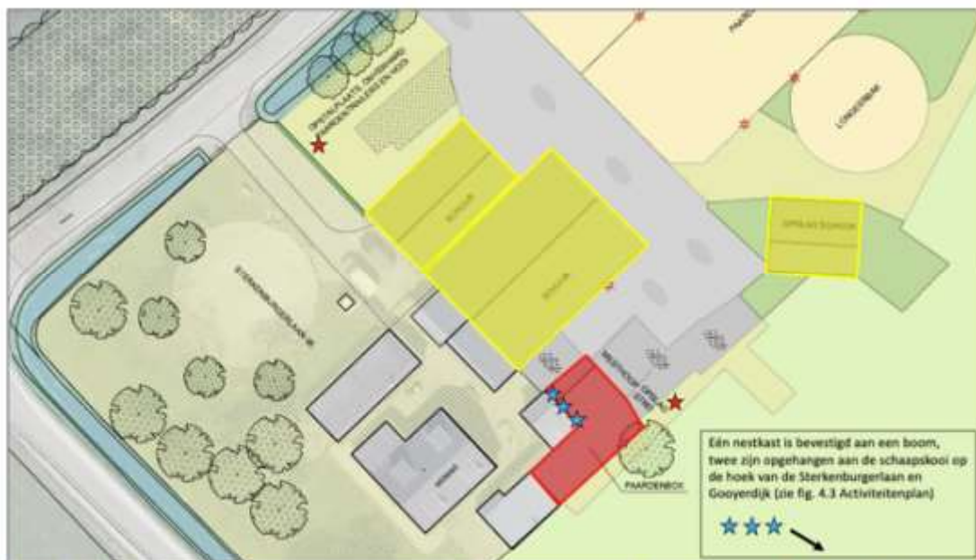
Figuur 1 | Plangebied met verbeelding van gefaseerde sloop (geel is fase 1, rood is fase 2) en gerealiseerde tijdelijke mitigatie (rode ster is huismussenpaalkast (2x12 nestplaatsen, blauwe ster is tijdelijke mitigatie 6x3 gecombineerde nestplaatsen).
